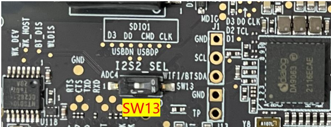
图表3-50 I2S2 拨码开关切换
